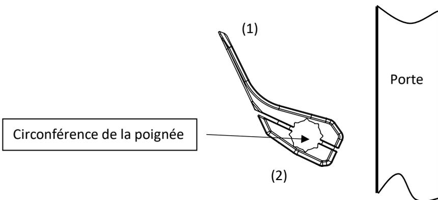
3. Vissez les 4 vis (3) afin que la poignée Protectiv™ Door soit bien maintenue. Il est recommandé d'utiliser un tournevis cruciforme. Ne pas utiliser une visseuse électrique. Arrêtez le serrage dès que la poignée Protectiv™ Door ne glisse plus ou une fois que les deux parties (1) et (2) sont en contact. Recommencez ces 3 étapes pour la seconde poignée de votre porte.
